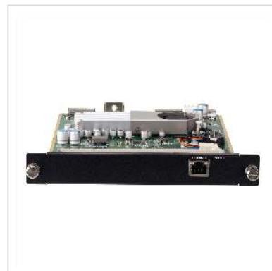
**Le VW-CPU peut être installé dans le processeur mural vidéo modulaire 4K ATEN VW3620 36 x 20, qui a deux emplacements pour carte CPU.**
