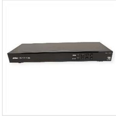
Le commutateur matriciel HDMI 4K 4x4 ATEN VM0404HA prend en charge des résolutions 4K de UHD (3840 x 2160) et DCI (4096 x 2160) avec des fréquences d'actualisation de 30 Hz (4:4:4) et 60 Hz (4:2:0). Prêt pour l'avenir de la commutation vidéo haute définition, le VM0404HA est idéal pour les applications où le routage des signaux numériques 4K est nécessaire, comme dans les salles de classe, auditoriums, grands magasins et plus.
