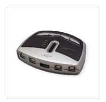
Le commutateur US421A est un commutateur de périphérique USB 2.0 à 4 ports qui permet à jusqu'à 4 ordinateurs de partager l'utilisation d'un même périphérique USB (tel qu'une imprimante, un scanner, un périphérique de stockage de masse, etc.) selon le principe « un à la fois ».
