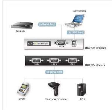
Le Hub avec convertisseur USB vers interfaces sérieelles RS-232 de ATEN offre à un ordinateur ou Notebook équipé d'une interface USB une connexion externe sérieelle Plug-and-Play. C'est la solution rapide, simple et de peu de coût pour les applications de communication et d'automatisation.
