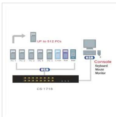
Le switch KVM CS1716A permet le contrôle de 16 serveurs via une console USB ou PS/2. Grâce au Daisy Chain, on peut gérer jusqu'à 512 serveurs. Un port USB en face avant permet à chaque serveur connecté d'avoir accès au périphérique connecté.
