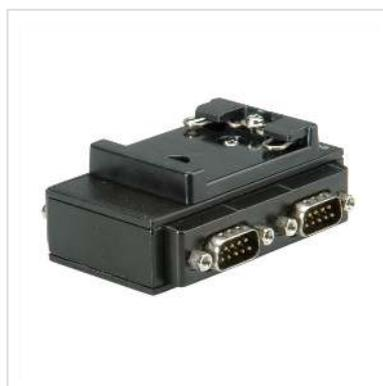
Convertisseur pour appareils sériels à connecter au port USB de l'ordinateur
