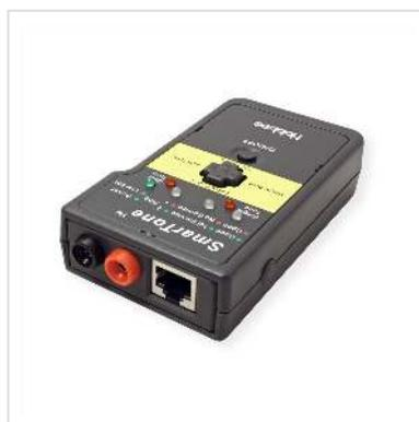
**Le testeur et traqueur de câble réseau SMARTone est un excellent outil d'installation et de dépannage du réseau. Il utilise la technologie de signal numérique avancée et trouve et identifie les câbles installés avec une grande précision et une vitesse élevée. La technologie numérique empêche le bruit et les signaux incorrects.**
