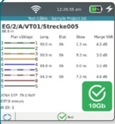
La touche **Test câble** permet de lancer directement un test de qualification.
