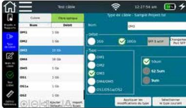
**Important:** Avant de réaliser un test, il est nécessaire de sélectionner le type de câble correct, autrement le résultat pourrait être faussé.
