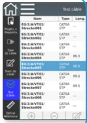
**Sur le côté droit** s'affiche le résultat de test du câble sélectionné à gauche
