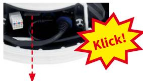
5. **Einsetzen der MicroSD-Karte:** Schieben Sie die MicroSD-Karte wie gezeigt (Kontakte in Richtung der Kuppel) mit einer Pinzette in den Karteneinschub. Stellen Sie sicher, dass beim Einschieben ein **Klicken** zu hören ist. Die Karte ist jetzt verriegelt und kann verwendet werden. **Beim Verwenden einer neuen MicroSD-Karte muss diese zuerst formatiert werden** (siehe Kapitel 3, «Inbetriebnahme der Kamera»).
