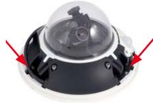
11. **Gehäusering montieren:** Positionieren Sie den Gehäusering so, dass die Aussparung im Ring (runde Öffnung) mit dem PIR-Sensor der Kamera übereinstimmt. Durch leichten Druck rastet der Ring in den drei vorgesehenen Halterungen im Gehäusesockel ein. **Alte Gehäuseringe (D10D, D12D) dürfen nicht mehr verwendet werden!**
