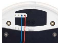
Nach dem Anschließen eines MxBus-Moduls muss zunächst der MxBus selbst (sofern noch nicht geschehen) als auch das Modul selbst in der Benutzeroberfläche der Kamera im Browser in Betrieb genommen werden (**Admin Menu > Hardware-Erweiterungen verwalten** bzw. **MxBus-Module verwalten**).
