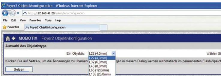
Wählen Sie jetzt im QuickControl **Anzeige-Modus** die Option **Objektivverzerrung**. Sie erhalten ein automatisch entzerrtes (Live-)Bild, in dem Sie alle vPTZ-Aktionen durchführen können. Durch Umschalten auf die Option **Vollbild** wird die automatische Entzerrungsfunktion wieder deaktiviert.
