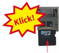
4. **Entnehmen der MicroSD-Karte:** Drücken Sie die MicroSD-Karte vorsichtig in die Halterung, bis ein Klicken zu hören ist. Die Karte steht jetzt etwas weiter heraus und lässt sich jetzt entnehmen (evtl. erleichtert eine Pinzette das Entnehmen).
