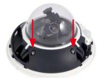
10. **Kabel fixieren:** Fixieren Sie das restliche Kabel in den Kabelführungen am Gehäuserand, sodass der Gehäusering später einwandfrei montiert werden kann.
