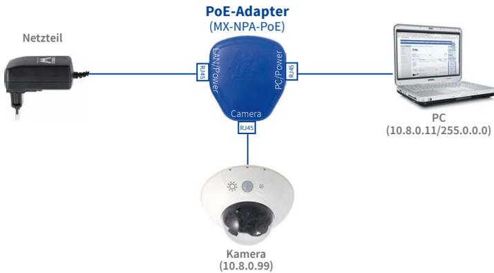
Verwenden Sie für die D16 das **blaue MX-NPA-PoE-Set** oder die **MX-NPA-Box** – das frühere **MOBOTIX** Netzwerk-Power-Zubehör NPA-Set, Power-Box und Power-Rack (MX-NPA-Set, MX-NPR-4 und MX-NPR8/20) ist für den Einsatz der D16 nicht geeignet!
