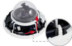
8. **Lage der Kabel kontrollieren:** Die beiden Kabel sollten jetzt vor den Anschlussbuchsen über Kreuz verlaufen.
