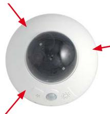
2. **Kabelabdeckung lösen:** Entfernen Sie die beiden Inbusschrauben M4x25 der Kabelabdeckung mit Hilfe des 3 mm-Inbusschlüssels.
