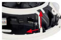
5. **USB-Kabel einführen:** Führen Sie das MOBOTIX USB-Kabel durch den Kabeldurchlass (siehe Abbildung) von unten ein und legen Sie es innerhalb der Kabelführung um die Kamera herum.
