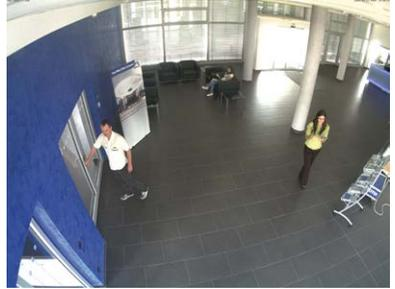
Dieser Effekt kann per Software z. B. im Browser unterdrückt werden, sodass ein neues und entsprechend korrigiertes Bild bereits live angezeigt werden kann. Nebeneffekt dieser Korrektur ist allerdings die Kissenform des Bildrahmens.
