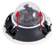
3. **Kabelabdeckung entfernen:** Wenn dies mit der Hand nicht gelingt, drücken Sie ein geeignetes Werkzeug (Schraubendreher) in die dafür vorgesehenen Vertiefungen (rote Pfeile). Hebeln Sie die Abdeckung vorsichtig nach oben in Richtung der Kuppel heraus.
