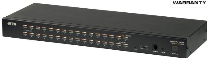
Les commutateurs KVM KH1532A sont des unités de contrôle qui permettent aux administrateurs informatiques d'accéder et de contrôler plusieurs ordinateurs depuis une seule console KVM PS/2 ou USB (clavier, moniteur et souris). Les opérateurs peuvent prendre le contrôle de jusqu'à 32 ordinateurs (KH1532A). En connectant en chaîne jusqu'à 31 commutateurs supplémentaires, vous pouvez contrôler jusqu'à 1024 ordinateurs depuis une console KVM centrale.
